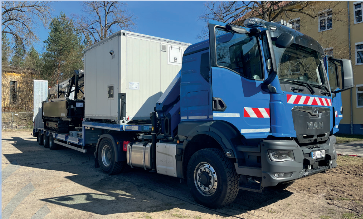
Mobile Basisstation Fuhrfahrzeug mit eingefah- renem Mast
