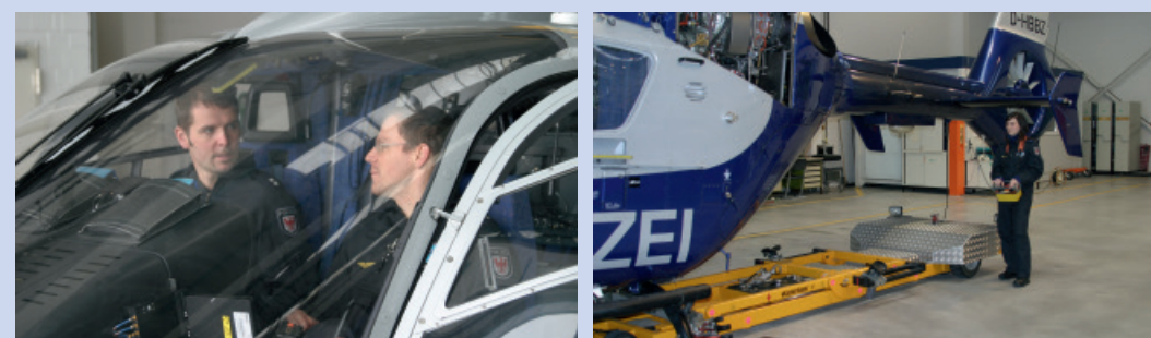
Systemcheck durch den Operator (Bild oben) Der Helilifter wird unter den Hubschrauber gefahren, kurz darauf folgt der Cockpit Check. (Bild unten) Die Kamerakugel samt Aufhängung wird geprüft. (Bild rechts)
