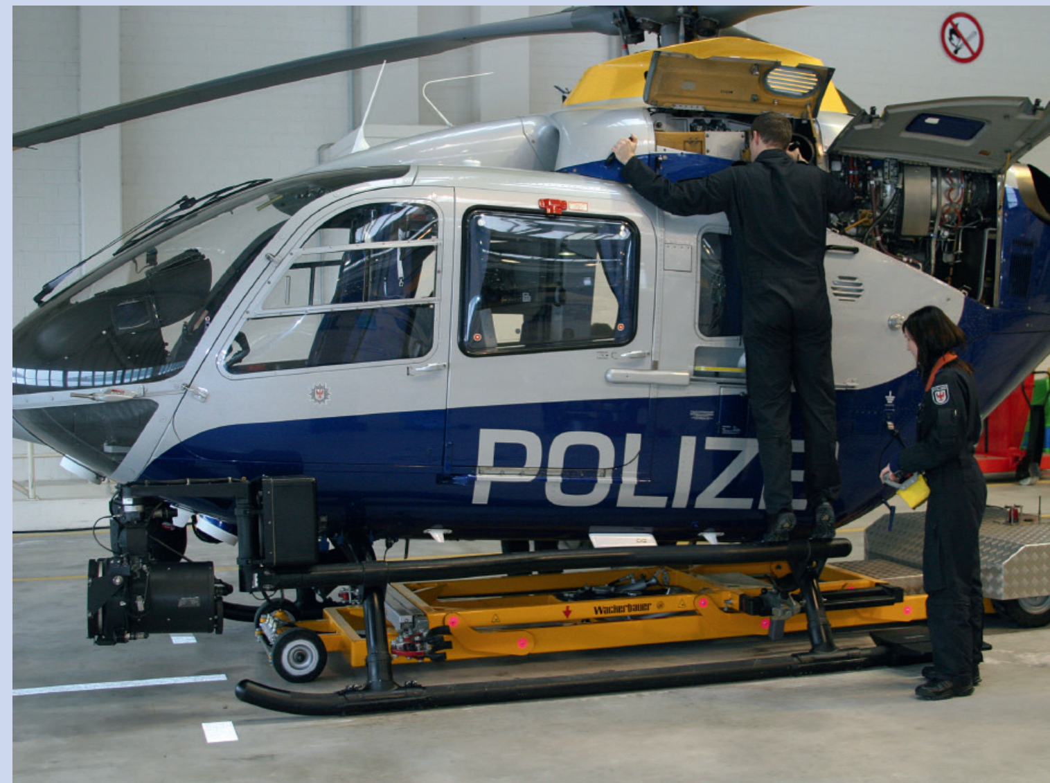
Letzte Prüfungen, zeitgleich rollt der Helilifter unter den Hubschrauber. (Bild oben) Suchscheinwerfer „trakkabeam“ (Bild links) Blick auf den neu ausgestatteten Arbeitsplatz des Operators (Bild rechts)
