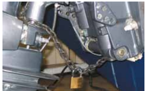
Sicherung eines Außenbordmotors mittels Kette und Schloss
