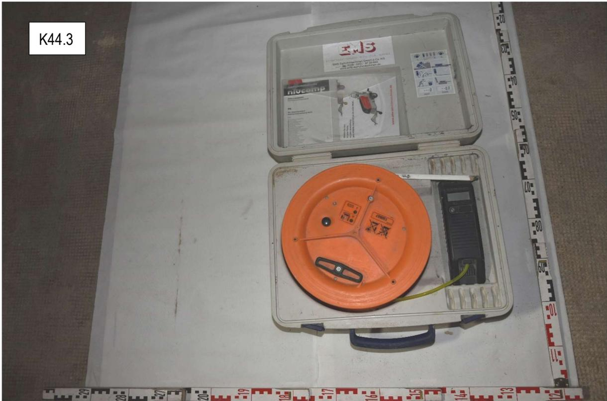
Inhalt Kuststoffkoffer: Schlauchwaage
