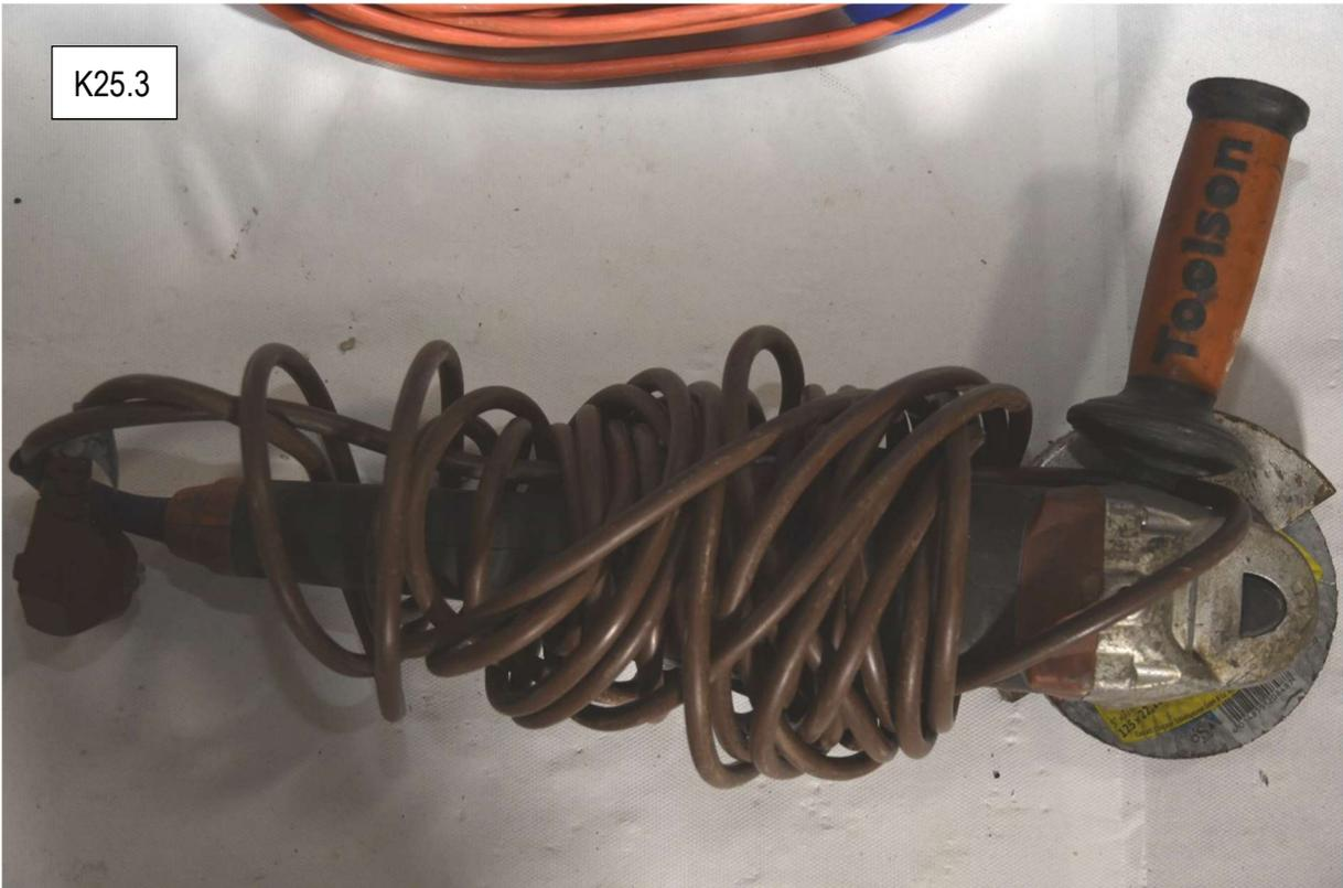
Winkelschleifer TOOLSON Pro WS900S mit nachträglichem Kabel
