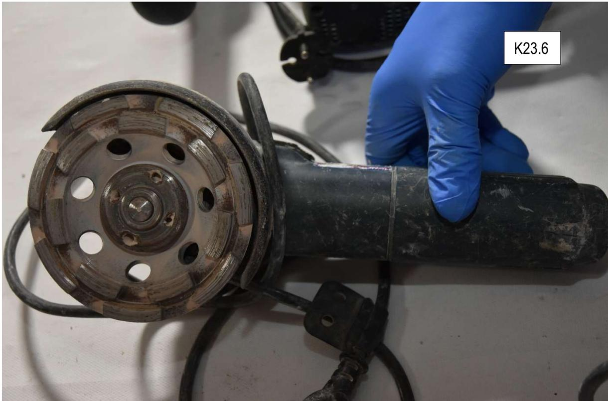
Winkelschleifer BOSCH mit Mauerschneider / Mauerscheibe
