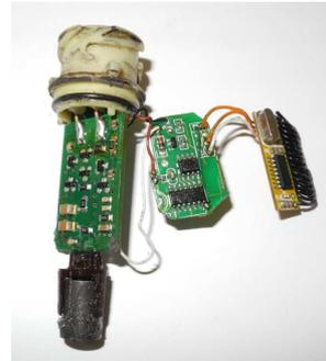
Am 13.11.2018 wurde auf der Tank- und Rastanlage Linumer Bruch ein rumänischer LKW kontrolliert und dabei eine Manipulation des Fahrtenschreibers mit dem dazugehörigen Getriebesensor festgestellt. In dem Getriebesensor wurde eine Zusatzplatine und ein Funkempfänger verbaut, um per Fernbedienung das Geschwindigkeitssignal auszuschalten und damit durch den Fahrtenschreiber „Ruhezeit“ aufzeichnen zu lassen.
