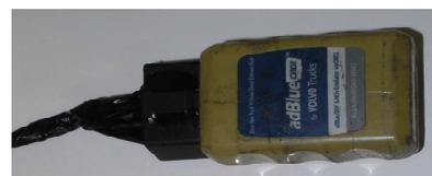
AdBlue-Emulator mit Anschlusskabel für den Datenbus des LKW
